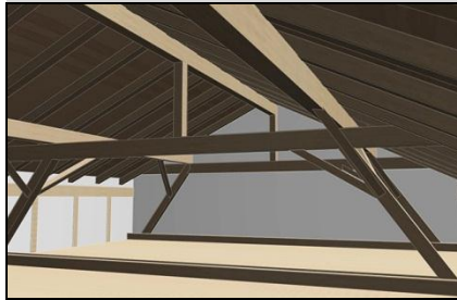
Tragkonstruktion: Stützen, Pfetten, Zangen, Sparren, Streben
